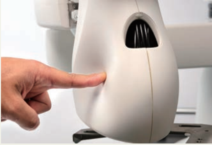
人体に当たっても大丈夫なようにアームカバーはウレタン製になっている。
