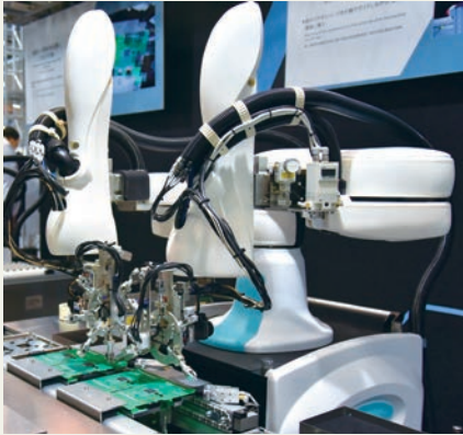
デュアロのアームにアタッチメントをつけることで、電子基板に部品を実装したり（左）、おにぎりを整列させてケースに詰めたり（中）といった、さまざまな作業ができるようになっている。右は専用タブレットを使い、デュアロに動作を教示している様子。
