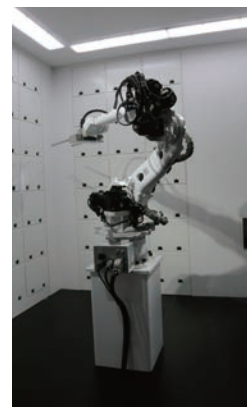
産業用ロボットの技術をクローク用に転用したロボットがエントランスにある。
