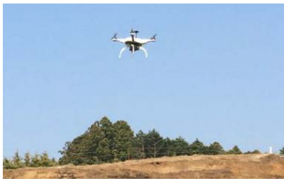
測量のため、ドローンを現場上空に飛ばす。所要時間の短さも精度の高さも、人力と比べ桁違いだ。
