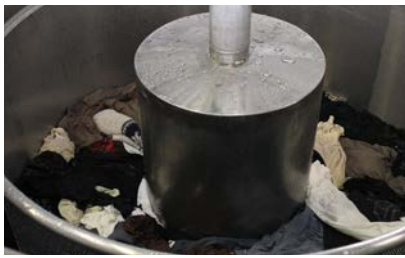
①リサイクルしてエタノールに変える綿製品はまず糖化酵素の溶液に浸け込まれ「糖化」される。
