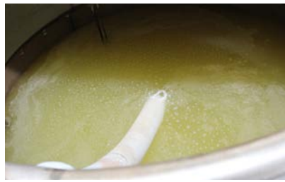
②そこでつくられた糖化液に酵母を添加してアルコールをつくり、それを蒸留して濃度を高めるとエタノールになる。様子。
