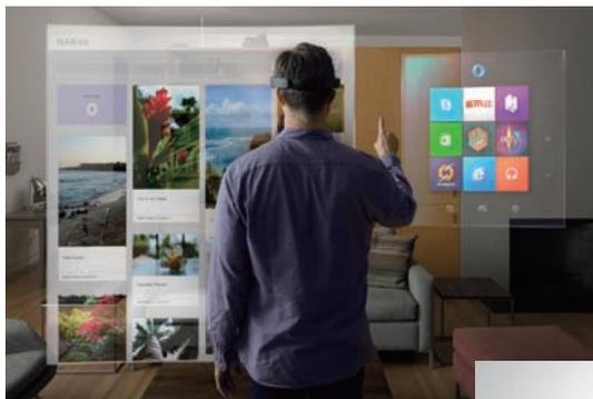
装着時に周囲の様子も同時に見えるシースルー型。装着時にパソコンやスマートフォンに接続する必要がなく、単体で使用できる。
