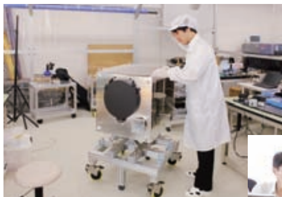
↑超小型衛星とは、多くの場合、重さが100kg以下の衛星を指す。写真(上)の衛星(試作品)は約600×600×800mmで80kg以下。製作は、社内、ビニールシートで囲まれた部屋で行われる。
