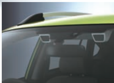
アイサイトのユニット本体（上）。左右の黒い部分の背後にカメラがあり、その間の距離は350mmある。運転席上部に搭載される（右）。
