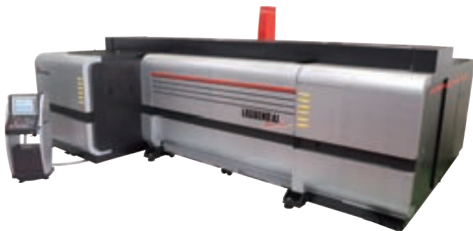
シートセンター LASBEND-AJ本体（左）。プログラムを入力して材料をセットすると製品が自動でつくられる「夢のマシン」だ。1個の試作品から量産まで対応する。大きさは縦約5.5メートル、横約7.1メートル、高さ2.5メートル。従来は加工工程ごとに4つのマシンが必要だったが、これがあれば1つで間に合う。上の図解は加工の流れを示す。
