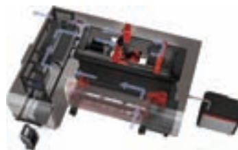
シートセンター LASBEND-AJ本体（左）。プログラムを入力して材料をセットすると製品が自動でつくられる「夢のマシン」だ。1個の試作品から量産まで対応する。大きさは縦約5.5メートル、横約7.1メートル、高さ2.5メートル。従来は加工工程ごとに4つのマシンが必要だったが、これがあれば1つで間に合う。上の図解は加工の流れを示す。
