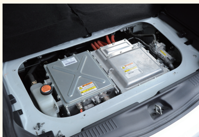
車体後部の荷物スペースの下にあるインバータ(右)と充電器(左)。この下部にPMモーターがある。電池の直流電源を交流に変えながら、その動きを制御するのがインバータの役割だ。
