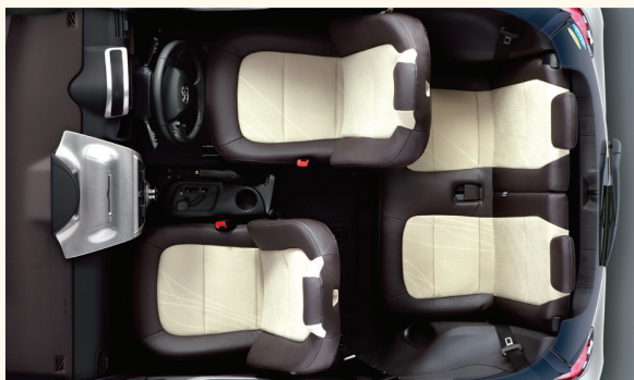
全長3メートルに満たないスペースだが、大人3人と子供1人が十分座れる。デフの反転配置、エンジンルームやエアコンのコンパクト化、ガソリントankの超薄型化と前席床下配置、薄型シートバックの採用、助手席側のインパネを大きくえぐったデザインなど、ありとあらゆる工夫の末に生まれた空間だ。
