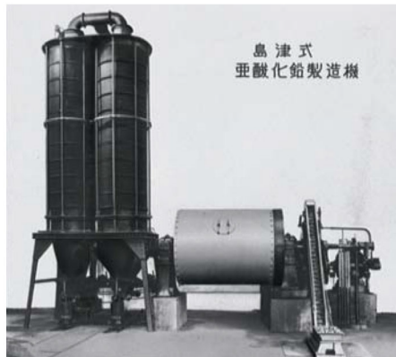
二代目島津源蔵が開発した亜酸化鉛製造機
