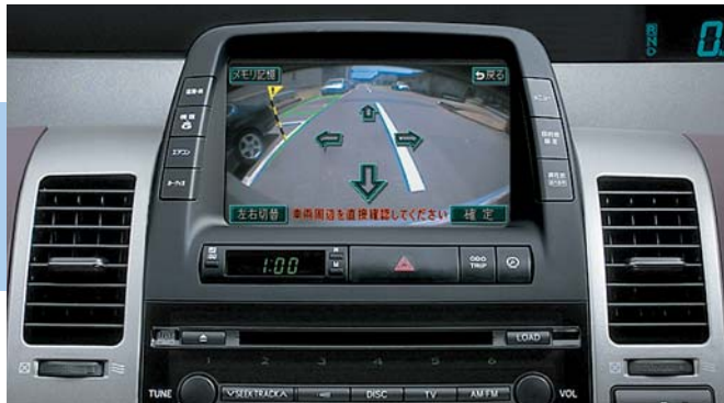
中央の画面がインテリジェント・パーキングアシスト。プレーキ操作のみで、縦列駐車や車庫入れなどを自動で行う。1999年に開発開始。
