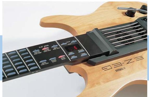
ネック部分はフレットごとに光スイッチが配され、通常の弦の部分は、弦の形状と、弾く感じを模した金属ワイヤーでできている。面倒な弦交換、チューニングはもちろん必要ない
