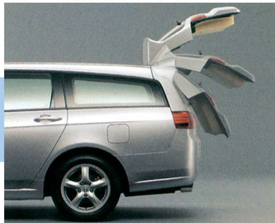
電動テールゲート 荷物の多い時などを想定し、リモコン操作で自動開閉が可能
