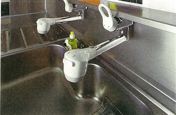
主婦のプロトタイプの商品開発によって生まれた主力シリーズ「レガセス」に隠された発明のひとつが、この「スペースアップカウンター」。奥行き125mmの棚を使いやすい位置につけ、水栓を棚の下につけた。小物や食材を棚の上に置けるうえに、カウンター部に水栓がないので掃除が楽になったと好評。
