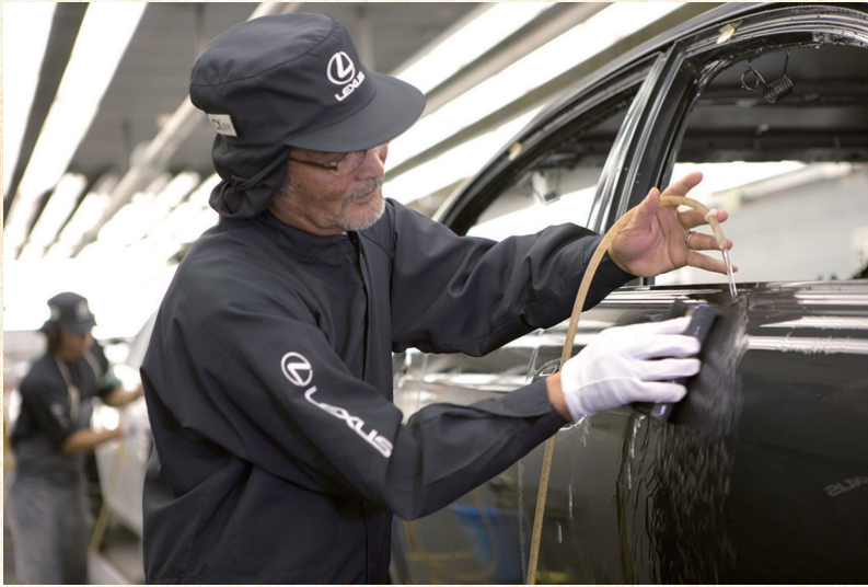
塗装の下地を磨く工程。高い品質を職人芸が支えている。
