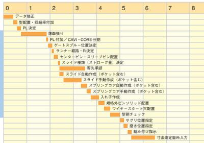
携帯電話の金型製作の45時間化を可能にした工程表の一部。上の目盛りは時間数を表わす
