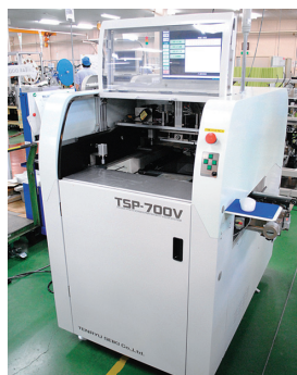
天竜精機の製品の1つ、「クリームハンダ印刷機」の新型機種。集積回路の基板に、自動でクリームハンダを印刷する。
