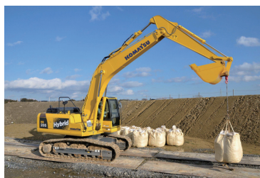
上：「ダントツ商品」の一例、ハイブリッド油圧ショベル。車体旋回の減速時に発生するエネルギーを電気エネルギーに変換し、エンジン加速時の補助エネルギーに活用する。
