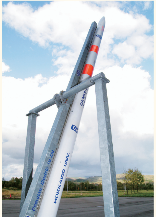
植松電機が製作したカムイ型ハイブリッドロケット。主燃料がポリエチレンのため、機体が壊れても二次災害が起きない安全性が売り物だ（右）。同社は、北海道のほぼ真ん中に位置する元炭鉱の町、赤平市にある。写真に写っている黒い建物は本文終盤に出てくる体験学習用の宿泊施設である（上）。
