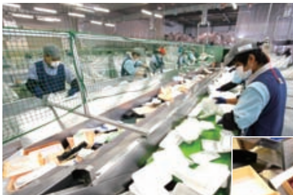
↑リサイクルトレーの選別。白いトレーは再生トレーの原料、色物は建築材料となる。「色物と白を分けるだけでなく、異物や不適格品、再度選別が必要なものを瞬時に見分ける。すごい集中力です」(藤井氏)
