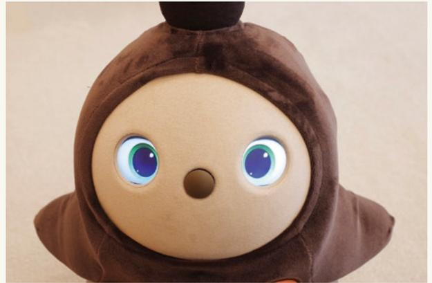
生命感を生み出すには目も重要な要素だ。6層の高精細液晶パネルを使って目の立体感と奥行きを表現するとともに、視線の動き、瞬きの速度、瞳孔の開き具合などにも徹底してこだわった。
