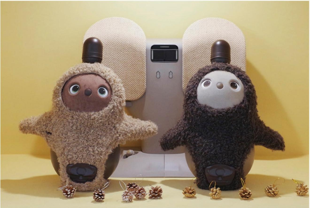
LOVOTはロボットなのに生き物のような生命感を持つ。角状の突起内に、360度見渡せる半球カメラ、人か物かを識別できる温度カメラ（サーモグラフィ）などが搭載されている。移動はタイヤで行い、静止時には体内に収まる。背後にあるのが充電ステーション「ネスト」。コンピュータが内蔵され、無線を通じてLOVOTと常時接続してさまざまな情報処理を行う。
