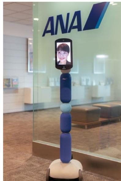
アバターロボット「newme」。“頭”の部分の画面に、アバターインした人の顔が映し出される。パソコンのカーソルキーで前後左右の移動を簡単に操作でき、ものや人にぶつかりそうになるとセンサーが働いて止まる仕組みだ。
