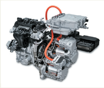
(左)直列3気筒の発電専用エンジンに、リーフで採用されている駆動モーターとインバーターが組み合わさった一体型パワートレイン。(中)大型の速度計と瞬間燃費、平均燃費、航続距離などを表示する車両ディスプレイを中央に配している。(右)インテリアの様子。
