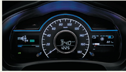
(左)直列3気筒の発電専用エンジンに、リーフで採用されている駆動モーターとインバーターが組み合わさった一体型パワートレイン。(中)大型の速度計と瞬間燃費、平均燃費、航続距離などを表示する車両ディスプレイを中央に配している。(右)インテリアの様子。
