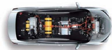
ミライを動かすトヨタフューエルセルシステム (TFCS)。中央や右寄りにある四角い銀色のものが、トヨタ初の量産型燃料電池。黄色の円筒は高圧水素タンク。左側の水素タンクの上に覆い被さっている四角い銀色のものが駆動用ニッケル水素バッテリーだ。
