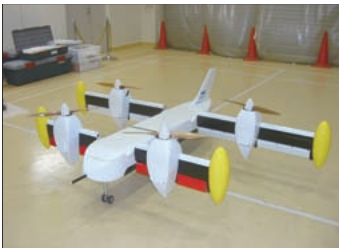
←アオキが、JAXAと共同開発を進めている小型の無人VTOL(垂直離着陸機)。病院間を飛ぶ、薬剤や臓器の緊急輸送などへの活用が期待される。 ↑金属や複合素材の航空機部品加工が、アオキの主力事業。写真は最新鋭機ボーイング787の金属部品を加工しているところ。
