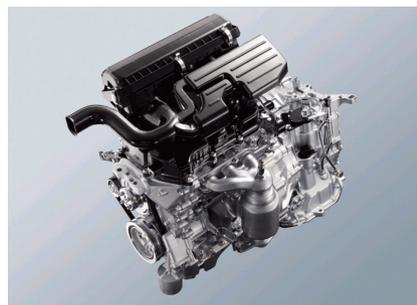
ミラ イースに搭載されているKF型エンジン。既存のエンジンをベースに、燃焼効率の向上と、部品一つひとつの改善によるエネルギーロスの低減を実現させた。
