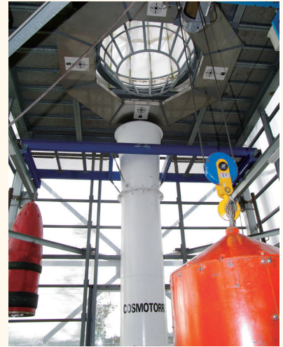
無重力実験施設の内部（上）と外観（左）。てっぺんから測定物を入れたカプセルを落とし、落下中の無重力状態時のデータを測定する。同様の施設はドイツにもう1つあるだけだ。
