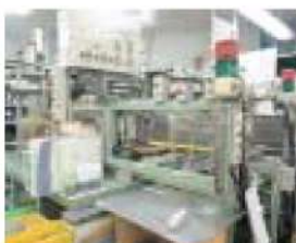
⑤ 旧来は専任オペレーターが 必要だった機械もこのとおり無 人化。レイアウトを45度変える ことと、仕上がり品を搬送する コロ・コンベアを取り付けるこ とにより、周辺工程の作業員が兼 務しながらこの機械を管理する ことが可能となった。
