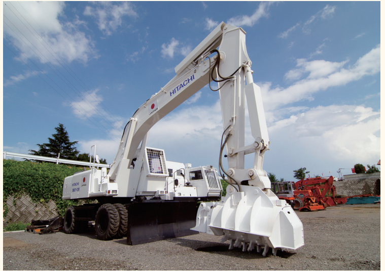
油圧ショベルを改良し、アームの先に Cutter 付きの回転ドラムを取り付けた対人地雷除去機（右）。ドラムは毎秒1000回という高速で回転しながら、深さ約30センチまでの土を攪拌する。その過程で土中に隠れている地雷を爆発させるのだ（上）。飛散した地雷の破片はマグネットで回収する。
