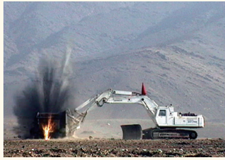
油圧ショベルを改良し、アームの先に Cutter 付きの回転ドラムを取り付けた対人地雷除去機（右）。ドラムは毎秒1000回という高速で回転しながら、深さ約30センチまでの土を攪拌する。その過程で土中に隠れている地雷を爆発させるのだ（上）。飛散した地雷の破片はマグネットで回収する。
